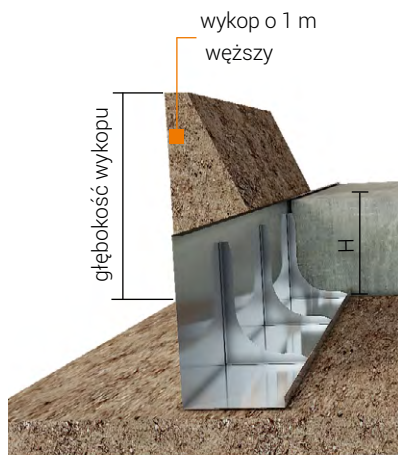
wykop fundamentowy - Formtec EDGE
